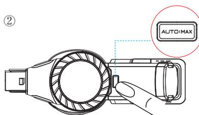
Le réglage par défaut est le mode AUTO après le démarrage de l'appareil ; il mettra 3 secondes pour vérifier s'il y a un blocage puis il détectera la quantité de poussières. Si aucune poussière n'est détectée, la puissance sera réduite à la puissance moyenne.
