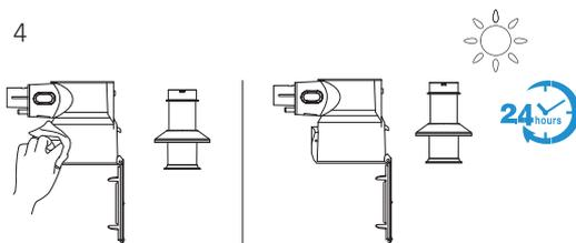
Nettoyez le bac à poussières et le filtre à mailles avec un chiffon humide. Les deux pièces doivent être complètement séchées à l'air avant de les remettre en place.
