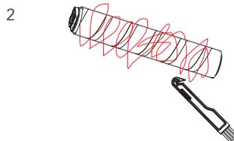
Enlever les poils et les débris enroulés autour du rouleau avec l'outil de nettoyage pour brosse.
