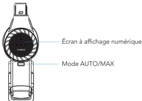
L'appareil est activé en mode AUTO par défaut. Après 3 secondes, appuyez sur le bouton AUTO/MAX pour passer en mode Max. Le bouton s'allume.
