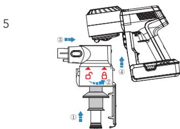
Insérez correctement le pré-filtre propre dans le filtre en maille, vous entendrez un « clic » indiquant qu'il est bien en place. Installez le receptacle à poussière propre et les filtres dans le corps principal, puis remplacez le couvercle du receptacle.
