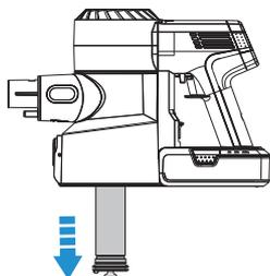
Veillez éteindre l'appareil avant le nettoyage et sortez le pré-filtre encrassé du porte-filtre en treillis.
