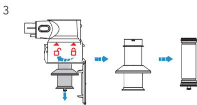
Tournez les filtres dans le sens inverse des aiguilles d'une montre et retirez-les.
