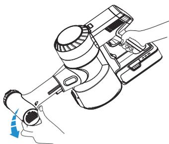
Activez l'appareil en mode MAX et faites pivoter le capot latéral pour nettoyer le pré-filtre encrassé. Retirez ensuite le filtre pour le sauvegarder après le nettoyage.
