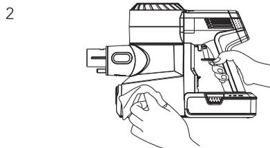
Nettoyez-le avec un chiffon humide. Ne laissez pas d'eau pénétrer dans l'appareil, surtout pas dans le moteur ni la batterie.
