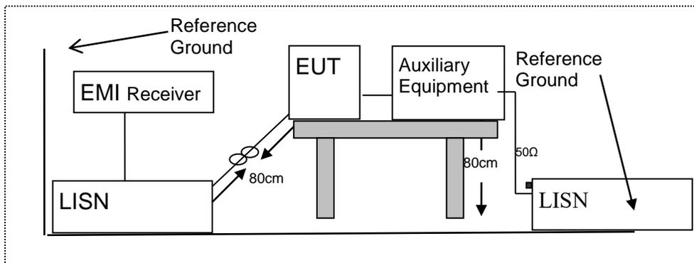
**6.4 BLOCK DIAGRAM CONFIGURATION OF TEST SYSTEM**
