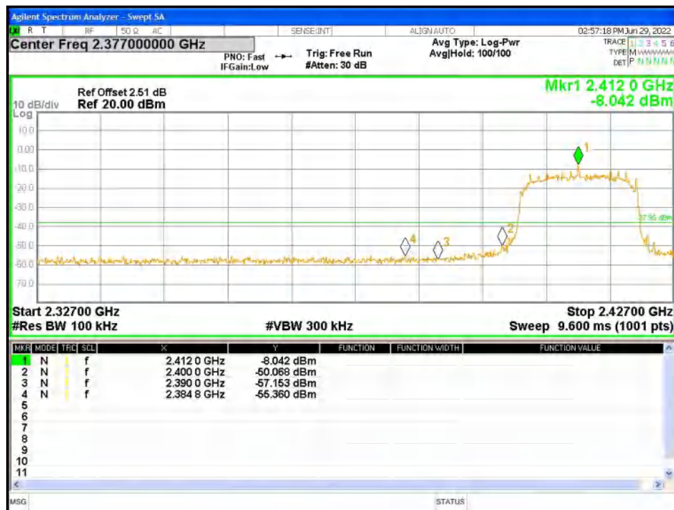
Band Edge NVNT n20 2462MHz Ant1 Ref
