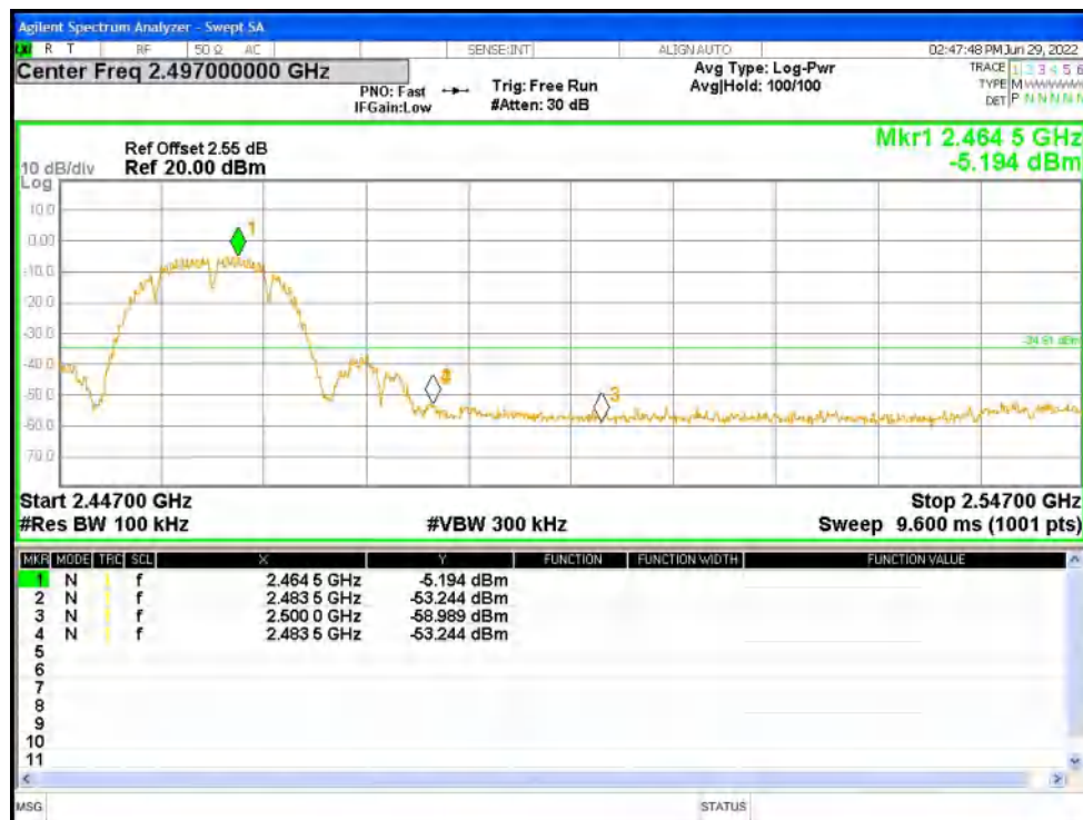
Band Edge NVNT g 2412MHz Ant1 Ref
