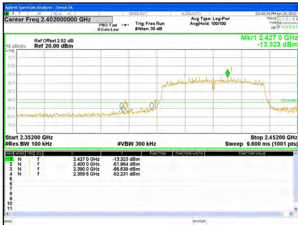
Band Edge NVNT n40 2452MHz Ant1 Ref
