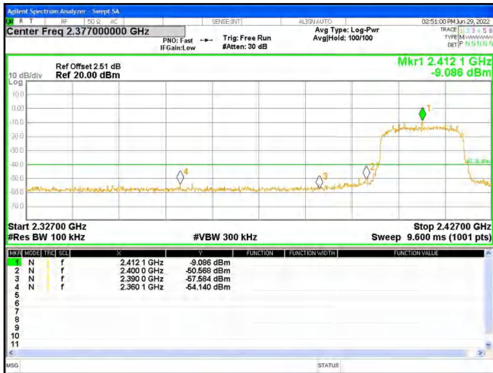
Band Edge NVNT g 2462MHz Ant1 Ref
