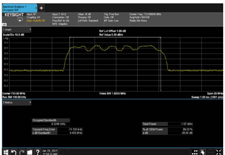
Figure 266: QPSK 10MHz B.W; 733.0MHz, 30kHz INPUT
