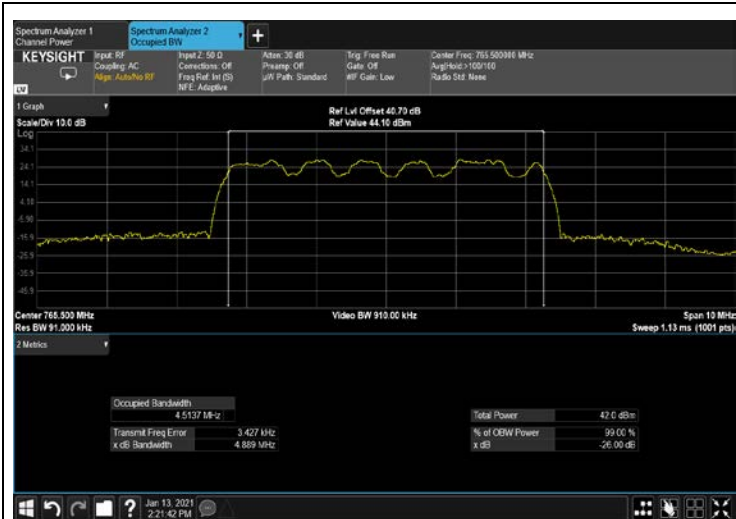
Figure 319: QPSK 5MHz B.W; 765.5MHz, 15kHz OUTPUT
