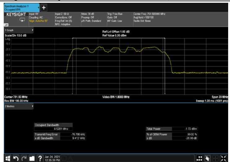
Figure 268: QPSK 10MHz B.W; 751.5MHz, 30kHz INPUT
