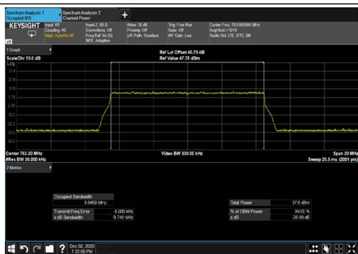
Figure 341: 64QAM 10MHz; 763MHz Input 4G
