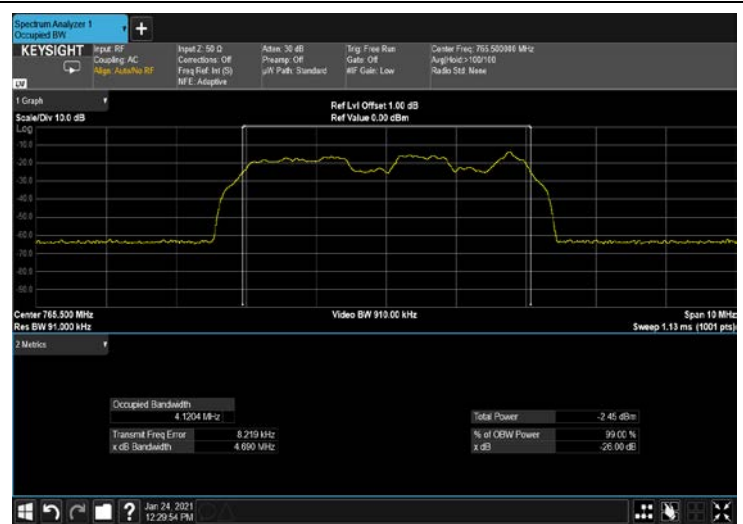
Figure 264: QPSK 5MHz B.W; 765.5MHz, 30kHz INPUT
