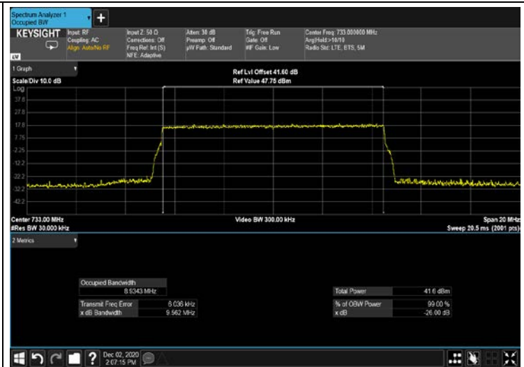
Figure 360: 64QAM 10MHz B.W; 733.0MHz output 4G
