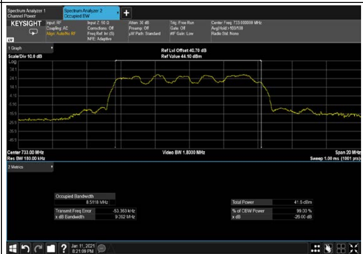
Figure 322: QPSK 10MHz B.W; 733.0MHz, 30kHz OUTPUT
