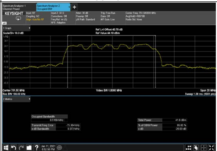
Figure 324: QPSK 10MHz B.W; 751.5MHz, 30kHz OUTPUT
