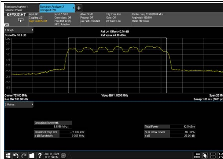
Figure 321: QPSK 10MHz B.W; 733.0MHz, 15kHz OUTPUT
