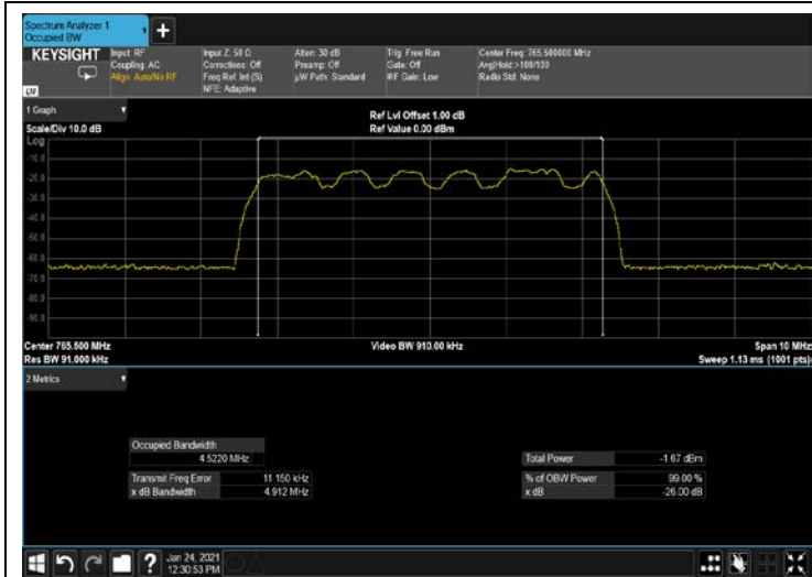
Figure 263: QPSK 5MHz B.W; 765.5MHz, 15kHz INPUT
