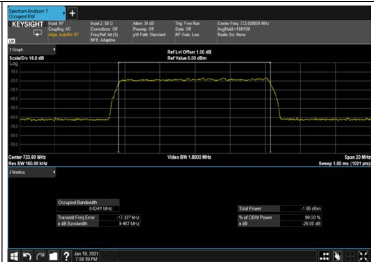
Figure 252: 256QAM 10MHz B.W; 733.0MHz, 30kHz INPUT
