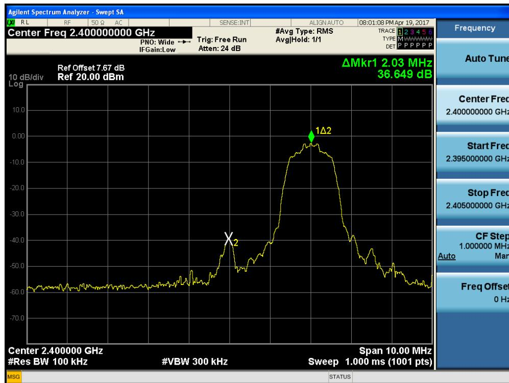
Test Plots without hopping ( $\pi/4$ DQPSK)
