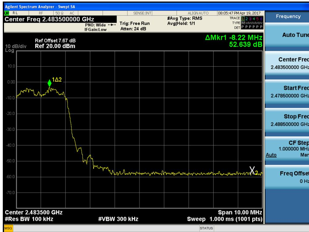
Test Plots with hopping ( $\pi/4$ DQPSK)
