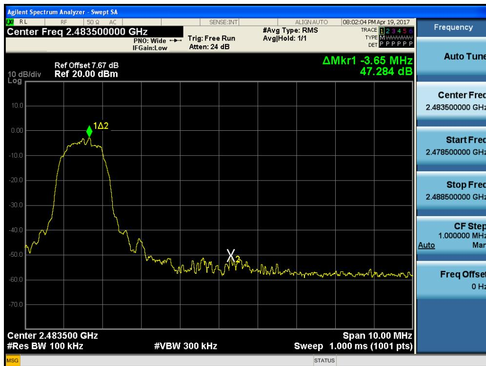
Test Plots without hopping ( $\pi/4$ DQPSK)
