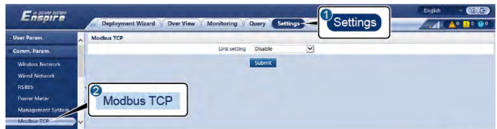
Figure 6-13 Setting Modbus TCP parameters
