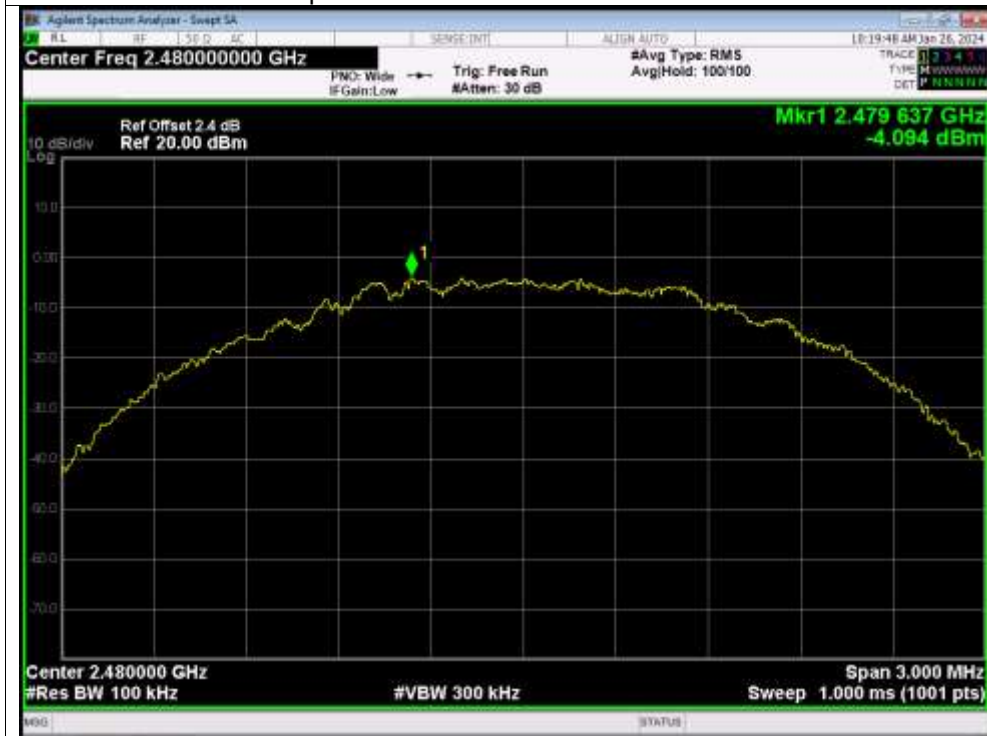
Tx. Spurious NVNT BLE 2M 2480MHz Emission
