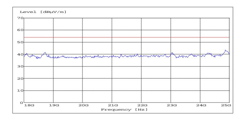
ANALYZER SETTINGS: f < 1 GHz: RBW/VBW: 100 kHz f 3 1GHz: RBW/VBW: 1 MHz
