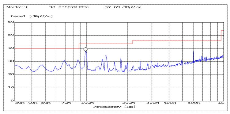
ANALYZER SETTINGS: f < 1 GHz : RBW/VBW: 100 kHz  $f \circ 1 \text{ GHz} : RBW/VBW: 1 \text{ MHz}$
