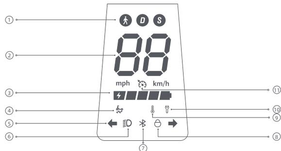
① Modes de conduite:
