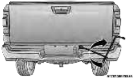
Rotating The Lug Wrench Handle
