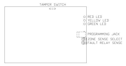
ZONE SENSE SETUP: JUMPER 1 AND 2 TO HAVE CIRCUIT ENERGIZE ON GROUND; JUMPER 2 AND 3 TO HAVE CIRCUIT ENERGIZE ON POSITIVE POTENTIAL. (ZONES 1 AND 2 ONLY) FAULT RELAY SENSE SETUP: JUMPER 1 AND 2 FOR A CLOSED CIRCUIT WHEN THE RELAY IS DE-ENERGIZED. JUMPER 2 AND 3 FOR A CLOSED CIRCUIT WHEN THE RELAY IS DE-ENERGIZED.
