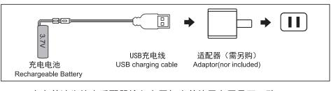
● 充电前请先检查适配器输入电压与当前使用电压是否一致;
