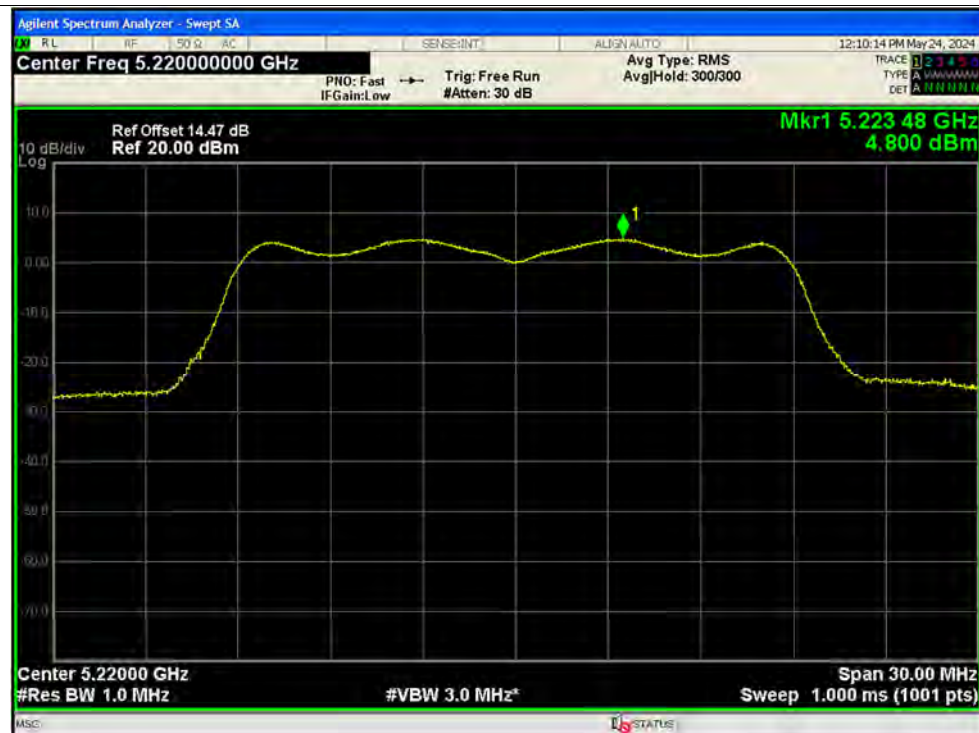
PSD NVNT n20 5220MHz Ant1
