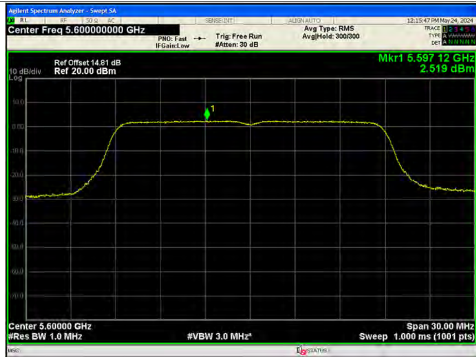
PSD NVNT n20 5720MHz Ant1
