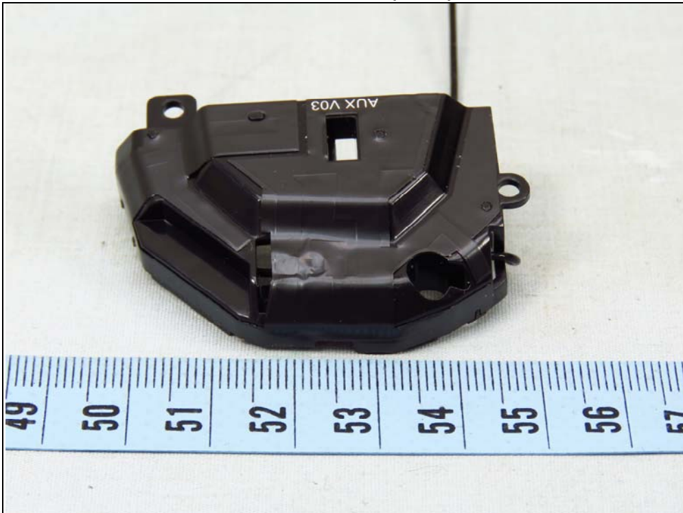
LTE antenna (Aux.)
