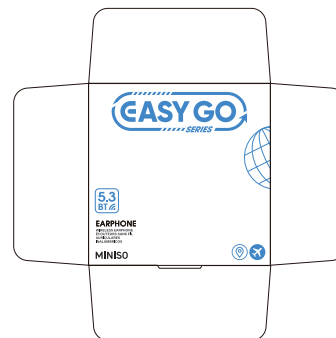
透明面盖 尺寸: 102*102*42MM 厚度: 0.4mm 透明PET胶片
