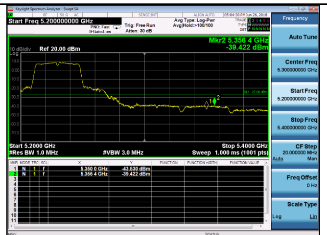
5150-5350MHz Band Edge - High CH 5310
