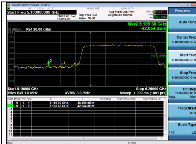
5150-5350MHz Band Edge - Low CH 5210
