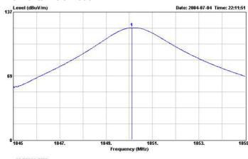
Site : 03CH03-HY Condition : 3m HORN-ANT-6821 HORIZONTAL EUT : GSM/GPRS handset 900/1800/1900 MHz
