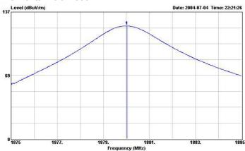
Site : 03CH03-HY Condition : 3m HORN-ANT-6821 HORIZONTAL EUT : GSM/GPRS handset 900/1800/1900 MHz
