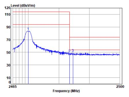
Site : chamber Condition: 3m VERTICAL : 02214ET/02215ET Mode : 2470 Band edge
