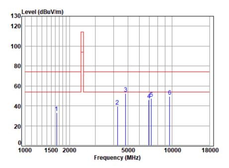
Site : chamber Condition: 3m VERTICAL : 02214ET/02215ET : 2413 TX RSE Mode
