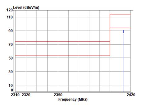
Site : chamber Condition: 3m VERTICAL : 02214ET/02215ET : 2413 Field Strengh Mode
