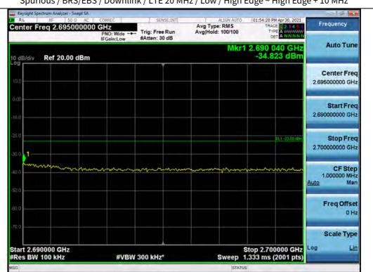
Spurious / BRS/EBS / Downlink / LTE 20 MHz / Low / High Edge ~ High Edge + 10 MHz
