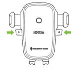
2. Presione su dispositivo contra el botón de activación del Easy One Touch. Los brazos de la montura se cerrarán automáticamente al entrar en contacto y sujetarán el dispositivo durante el viaje.
