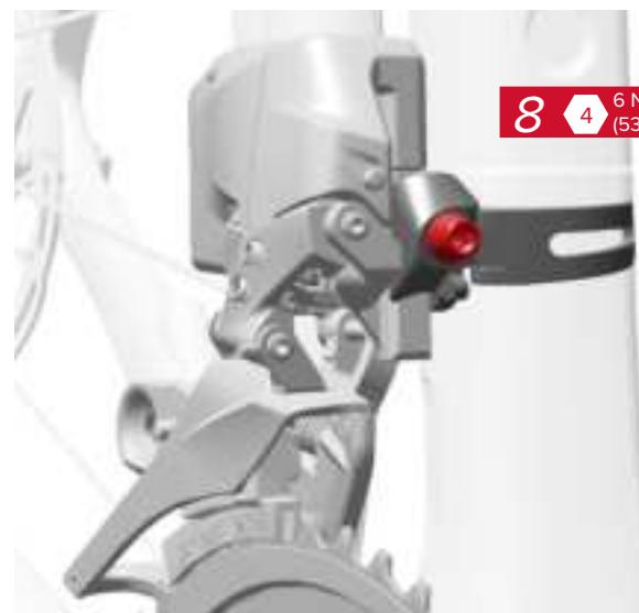
Faites tourner le pédalier et le dérailleur avant vers l'avant jusqu'à ce que le dérailleur touche le collier. Ajustez la hauteur du collier si nécessaire pour l'aligner avec le trou de la vis du dérailleur.
