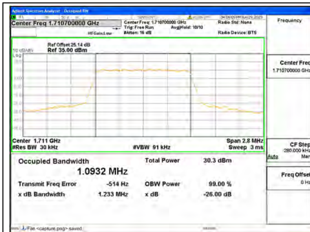
Band4 / 1.4MHz / QPSK/ Low CH
