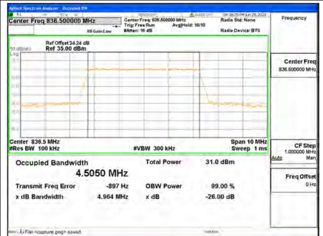
Band5 / 5MHz / QPSK/ Mid CH
