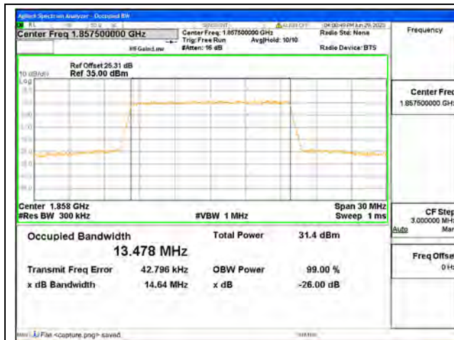
Band2 / 15MHz / QPSK/ Low CH
