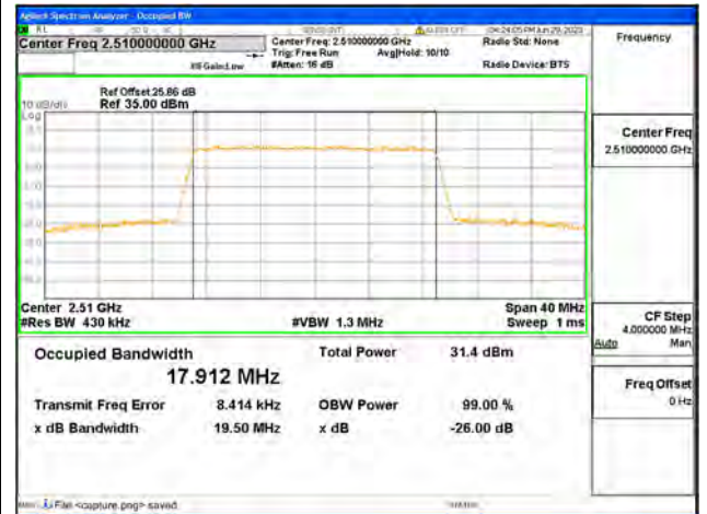
Band7 / 20MHz / QPSK/ Low CH
