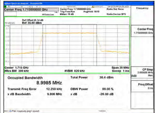
Band4 / 10MHz / QPSK/ Low CH
