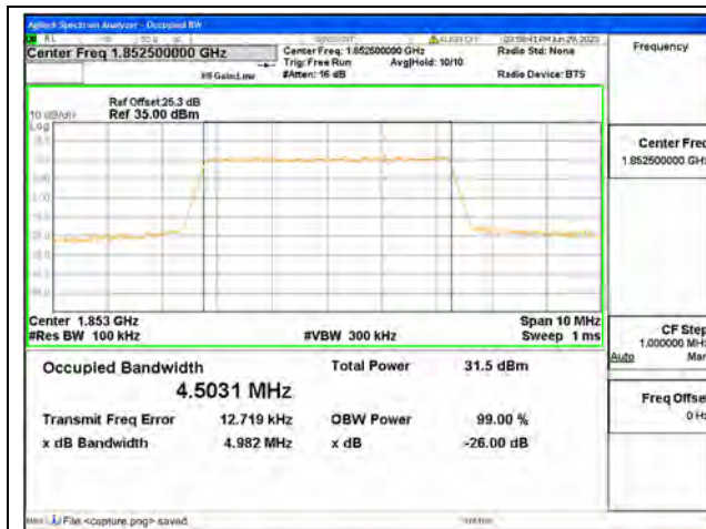
Band2 / 5MHz / QPSK/ Low CH
