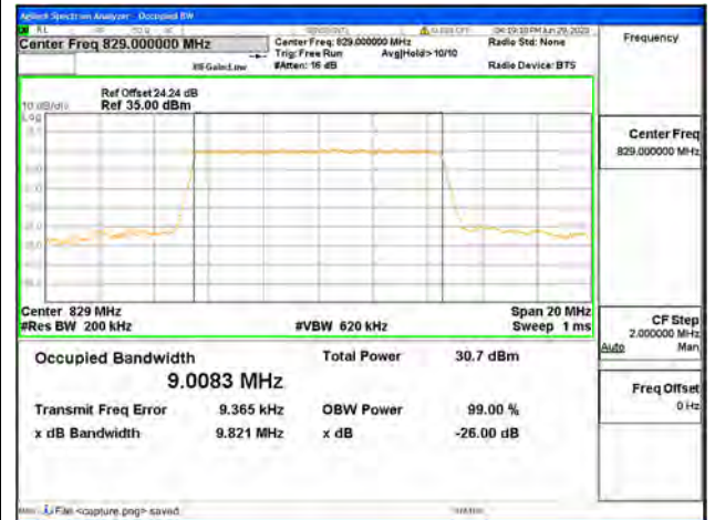
Band5 / 10MHz / QPSK/ Low CH
