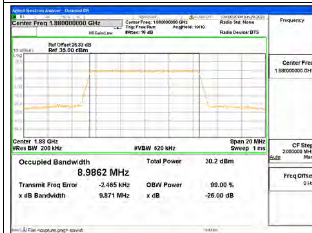
Band2 / 10MHz / 64QAM / Mid CH
