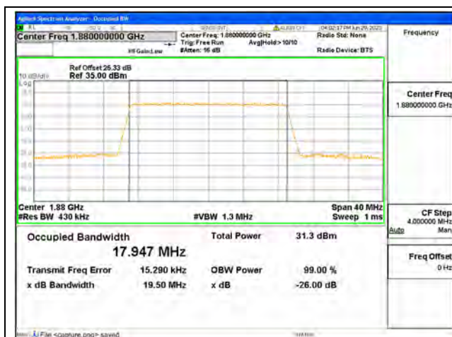
Band2 / 20MHz / QPSK/ Mid CH
