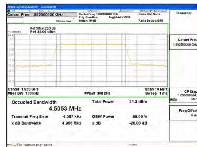
Band25 / 5MHz / QPSK/ Low CH
