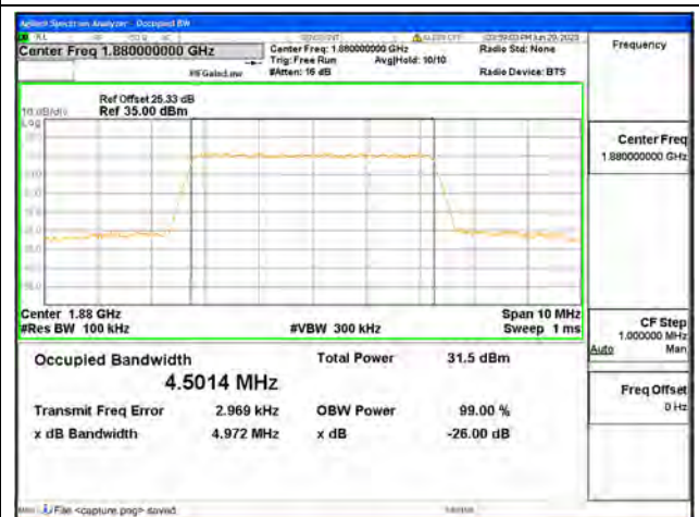
Band2 / 5MHz / QPSK/ Mid CH
