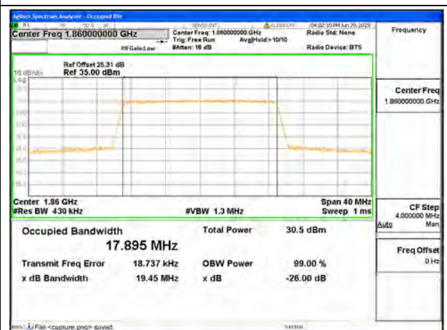
Band2 / 20MHz / 64QAM/ Low CH
