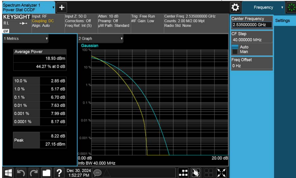
Sub6 n7. PAR Plot (40 M BW_Ch.507000_256QAM)
