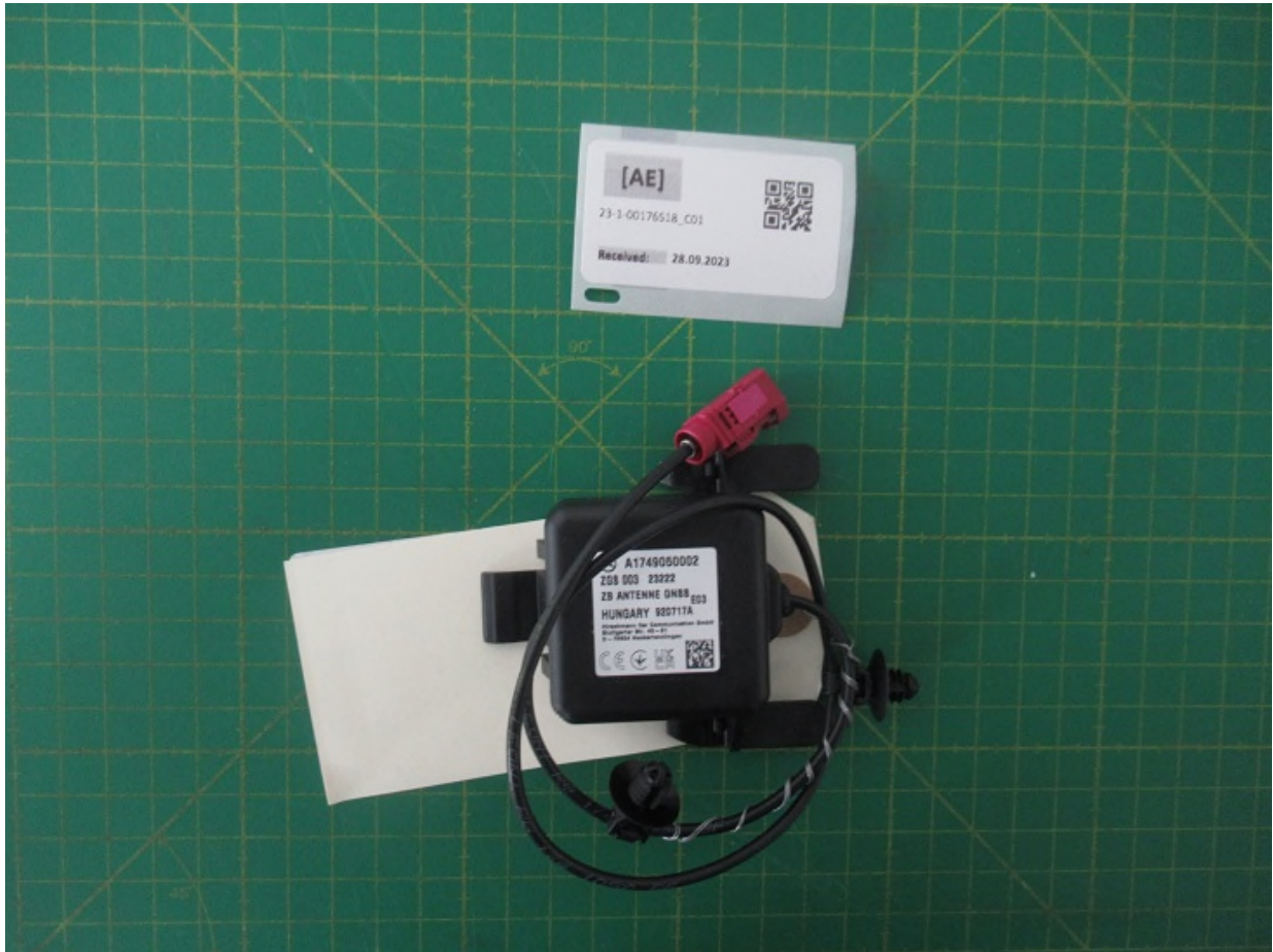
Fig. Ext.: 7 : Ext. - Front external GNSS antenna
