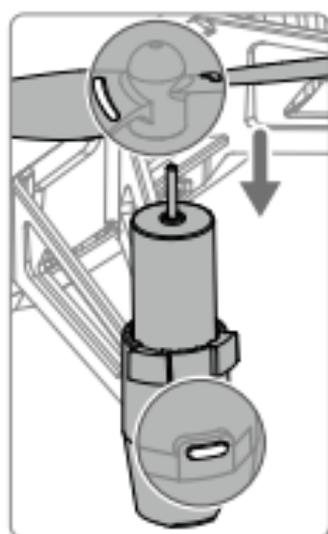
Установите пропеллеры с маркировкой на двигателях с промаркированными посадочными шасси.
