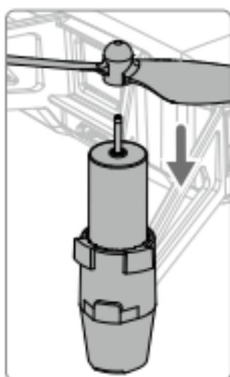
Установите пропеллеры без маркировки на двигателях с непромаркированными посадочными шасси.
