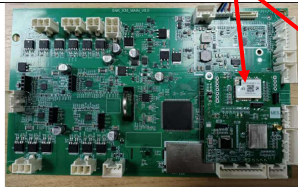
LORA module 3, FCC ID: 2A92VQD302
