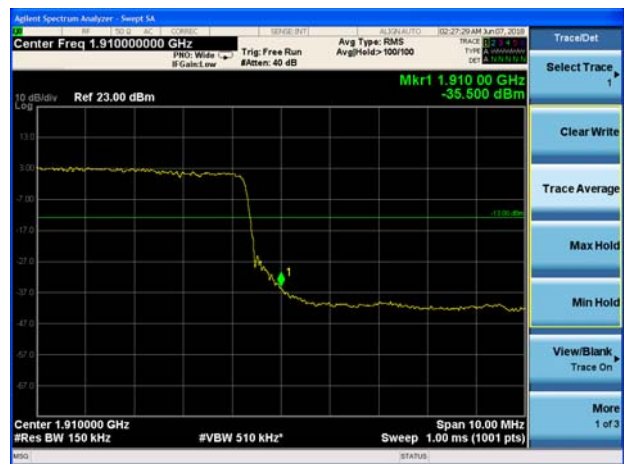
LTE Band 2 20MHz QPSK 1RB CH-High
