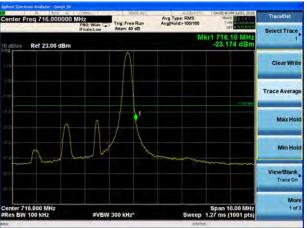
LTE Band 12 QPSK 3MHz CH-Low, 1 RB 698MHz~699MHz
