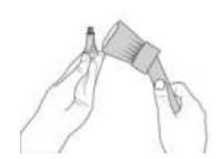
Apply lubricant to the valve stem. Aplique lubricante en el vástago de la válvula.
