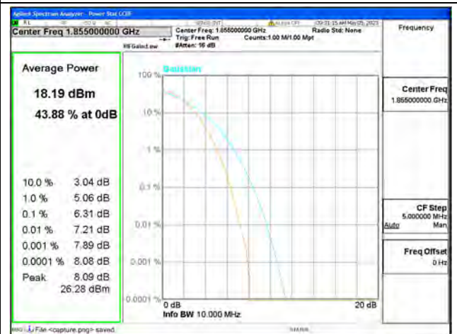
Band2 / 10MHz / Low CH / 64QAM
