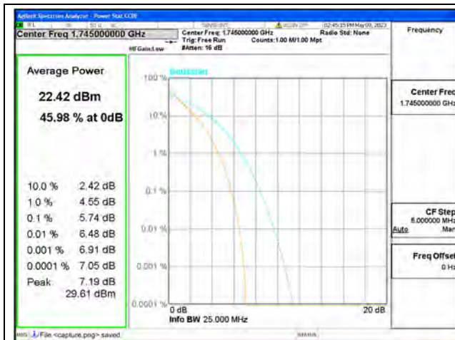
Band66 / 20MHz / Mid CH / QPSK
