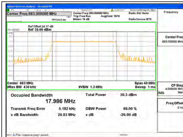
Band71 / 20MHz / QPSK/ Mid CH
