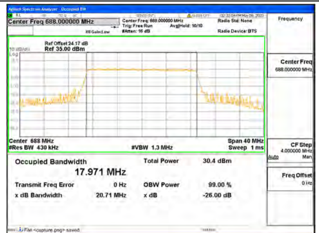
Band71 / 20MHz / QPSK/ High CH
