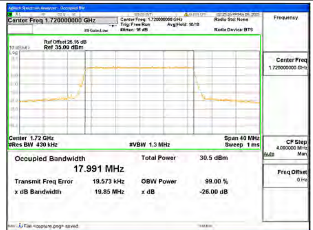
Band66 / 20MHz / QPSK/ Low CH
