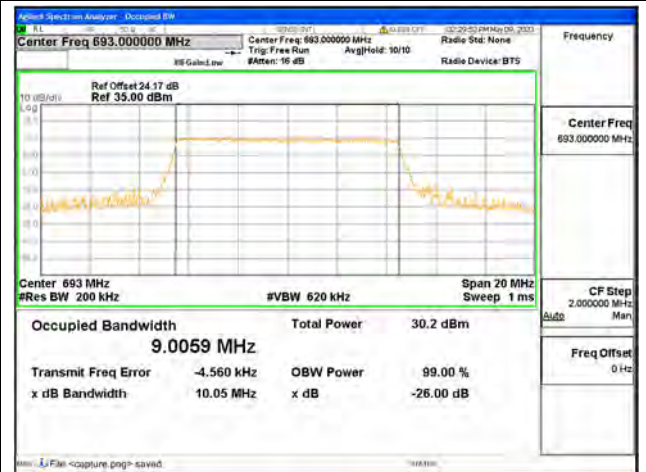
Band71 / 10MHz / QPSK/ High CH
