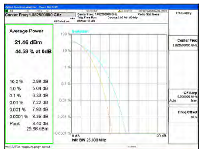
Band25 / 20MHz / Mid CH / 16QAM
