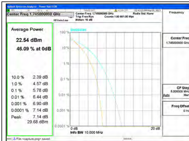
Band66 / 10MHz / Mid CH / QPSK
