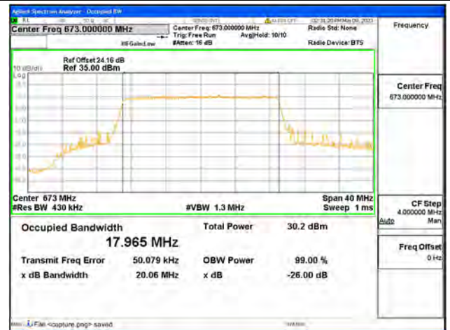
Band71 / 20MHz / QPSK/ Low CH
