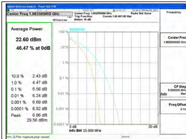
Band25 / 20MHz / Mid CH / QPSK
