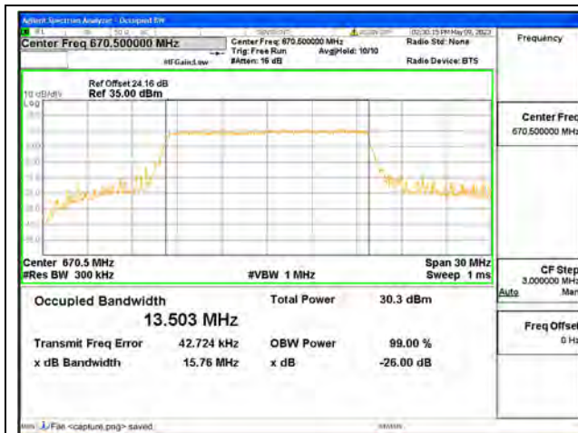
Band71 / 15MHz / QPSK/ Low CH
