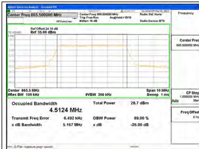
Band71 / 5MHz / QPSK/ Low CH
