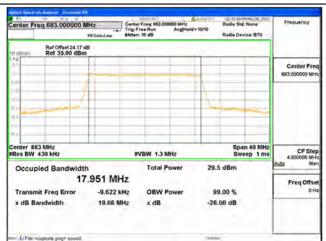
Band71 / 20MHz / 16QAM/ Mid CH
