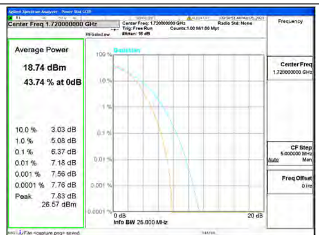
Band4 / 20MHz / Low CH / 64QAM
