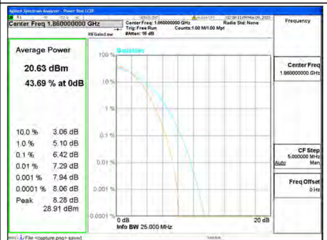
Band25 / 20MHz / Low CH / 64QAM
