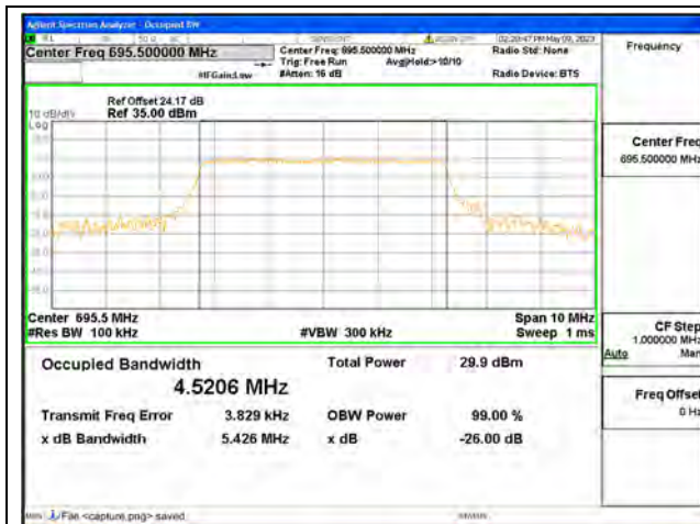
Band71 / 5MHz / QPSK/ High CH
