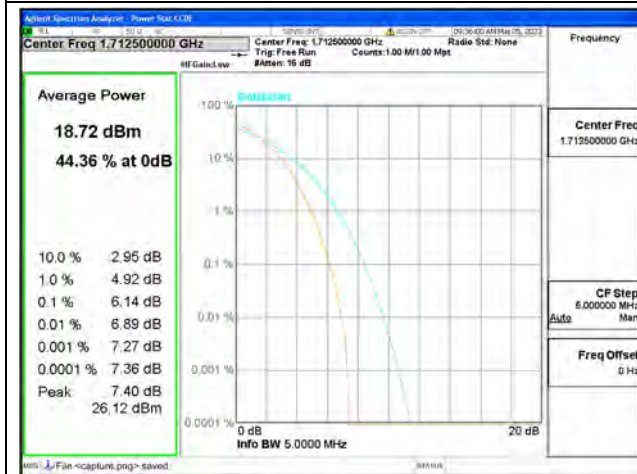
Band4 / 5MHz / Low CH / 64QAM
