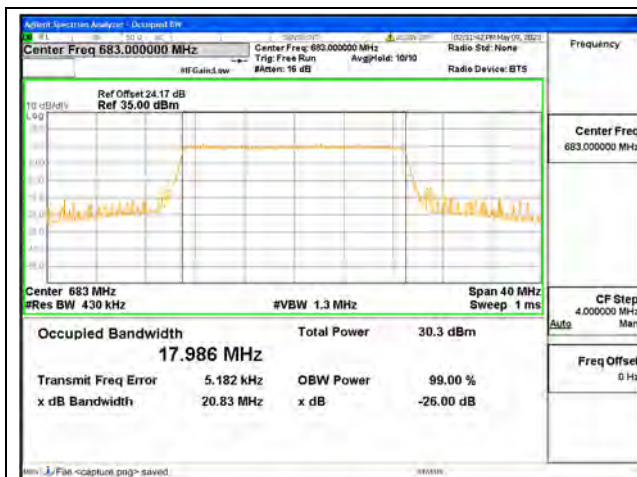
Band71 / 20MHz / QPSK/ Mid CH
