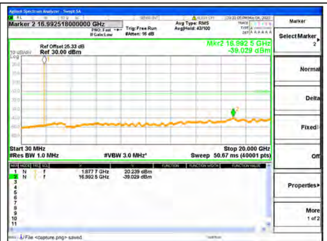
Band2 / 5MHz / Mid CH / QPSK
