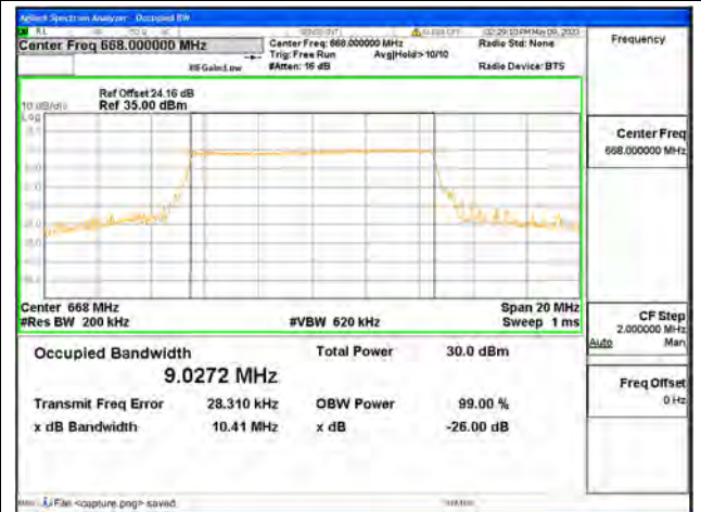
Band71 / 10MHz / QPSK/ Low CH
