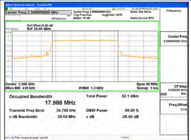
Band41 / 20MHz / QPSK/ Low CH
