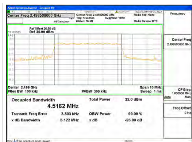
Band41 / 5MHz / QPSK/ Low CH
