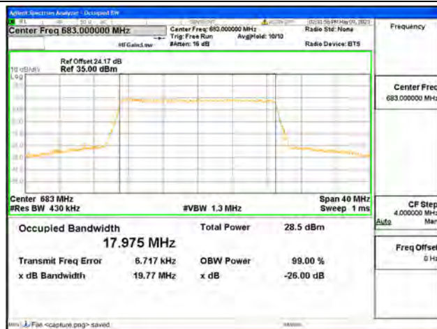
Band71 / 20MHz / 64QAM/ Mid CH
