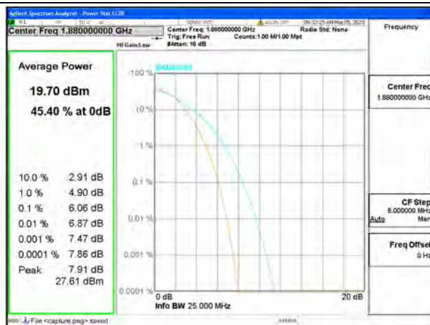
Band2 / 15MHz / Mid CH / 16QAM
