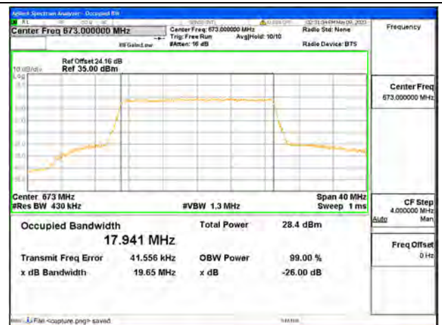
Band71 / 20MHz / 64QAM/ Low CH
