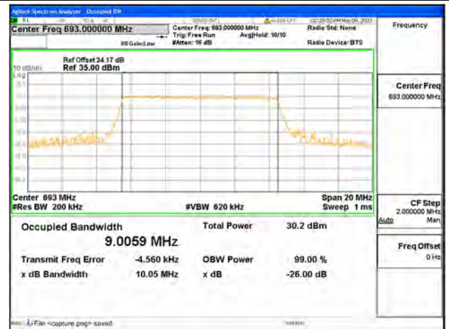
Band71 / 10MHz / QPSK/ High CH
