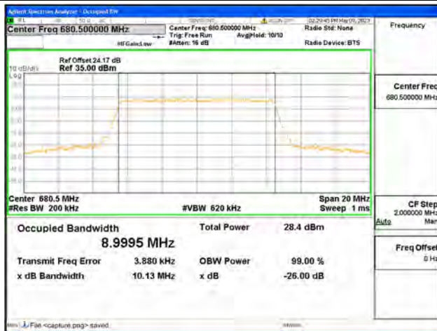
Band71 / 10MHz / 64QAM/ Mid CH
