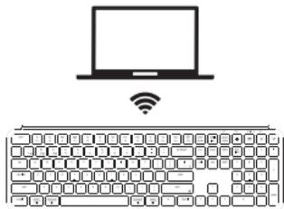
将2.4GHz接收器连接到设备USB端口。
