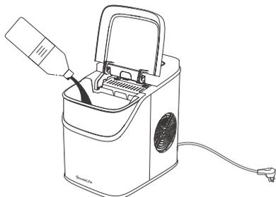
3. Utilisez l'eau pour rincer les parties intérieures et évacuez l'eau en débranchant le bouchon de vidange situé sur la partie inférieure avant.
