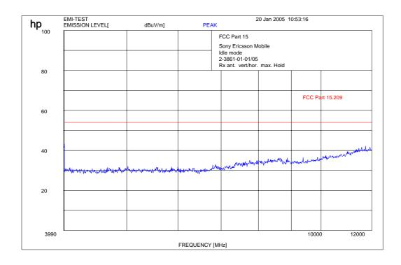
f < 1 GHz : RBW/VBW: 100 kHz  $f \ge 1GHz: RBW/VBW 1 \text{ MHz}$
