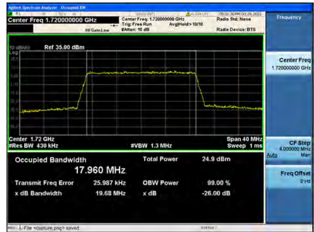
Band4 / 20MHz / Mid CH / 16QAM
