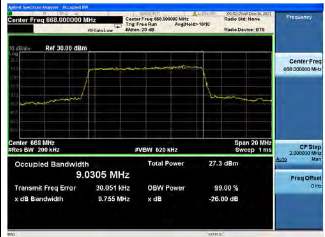
Band71 / 10MHz / Mid CH / 16QAM
