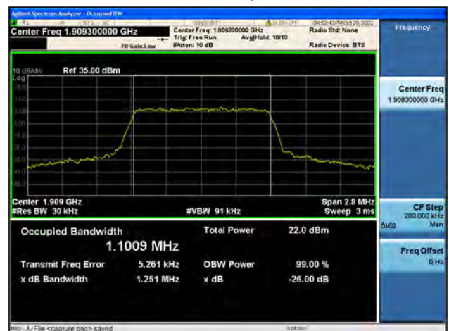
Band2 / 1.4MHz / High CH / 16QAM
