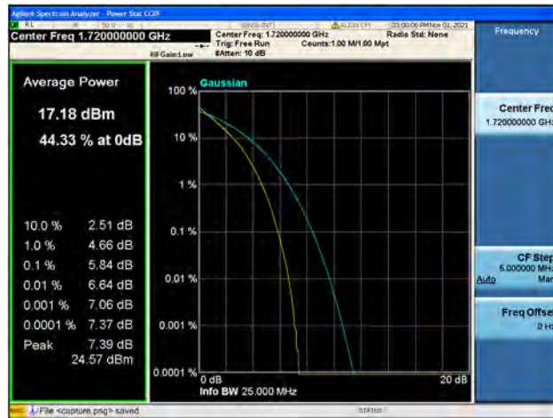
Band4 / 20MHz / Mid CH / QPSK
