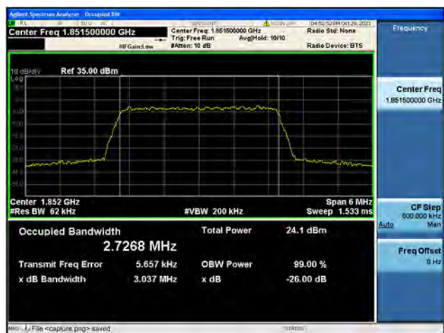
Band2 / 3MHz / Mid CH / QPSK
