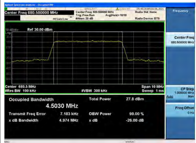
Band71 / 5MHz / High CH / 16QAM
