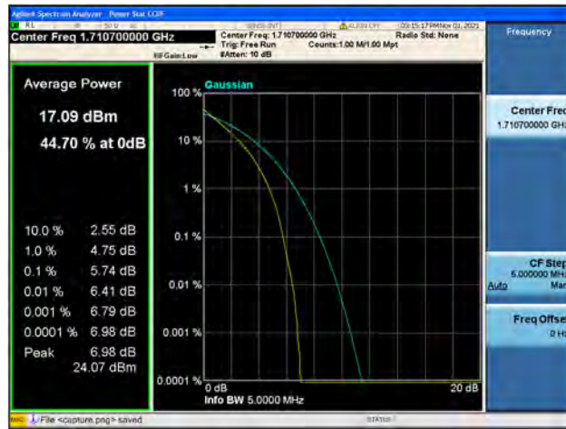
Band66 / 1.4MHz / Mid CH / QPSK
