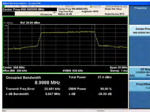
Band71 / 10MHz / Mid CH / QPSK
