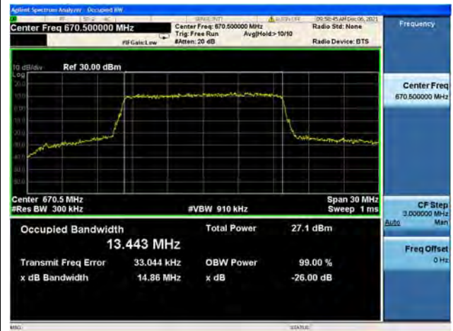
Band71 / 15MHz / Mid CH / 16QAM
