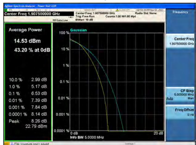
Band2 / 5MHz / High CH / 16QAM
