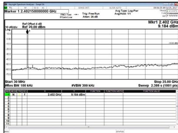
Modulation Standard:  $\pi/4$  DQPSK (2Mbps)
