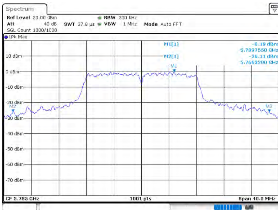
-26 dB BW NVNT 802.11a 5785MHz Ant 3
