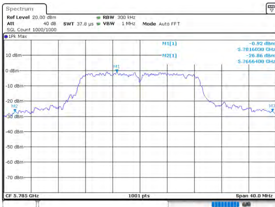
-26 dB BW NVNT 802.11n(HT20) 5785MHz Ant 4
