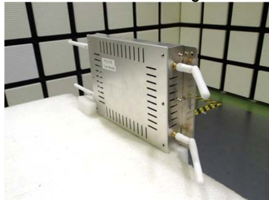
EUT Y-axis Antenna 45 deg
