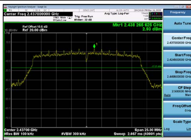
,Plot 2,Band Edge-802.11n(HT20) ,2412MHz,Ant0
