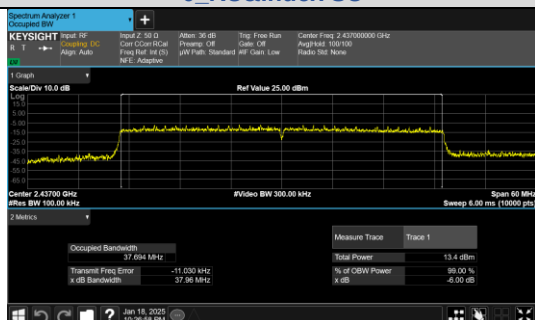
IEEE 802.11ax_Channel 6_40MHz_Antenna 0_RU&Index SU
