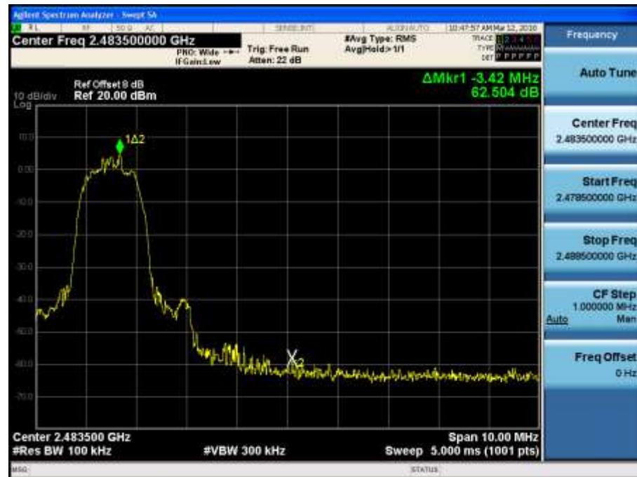
Test Plots without hopping ( $\pi/4$ DQPSK)
