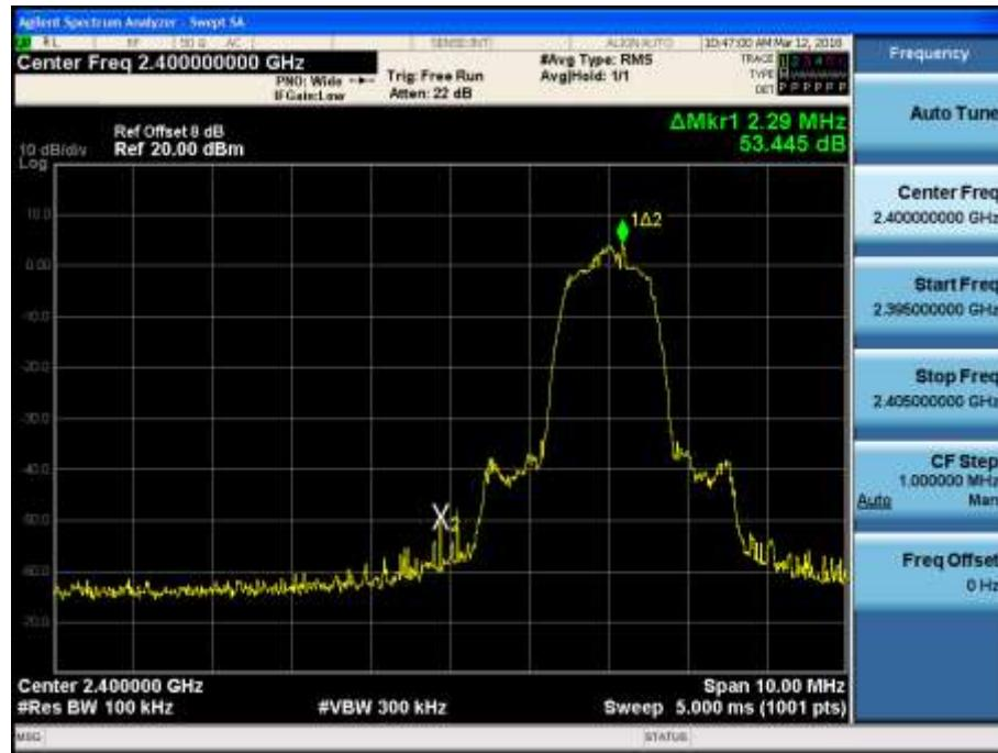
Test Plots without hopping ( $\pi/4$ DQPSK)
