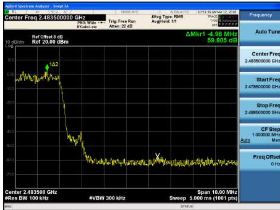
Test Plots with hopping ( $\pi/4$ DQPSK)
