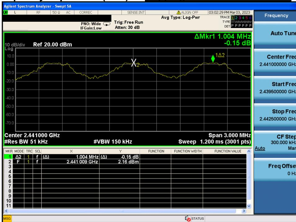
**Carrier Frequency Separation (AFH) *Hopping mode : Enable& $\pi/4$ DQPSK***
