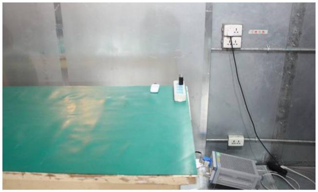
**RADIATED EMISSION TEST**
