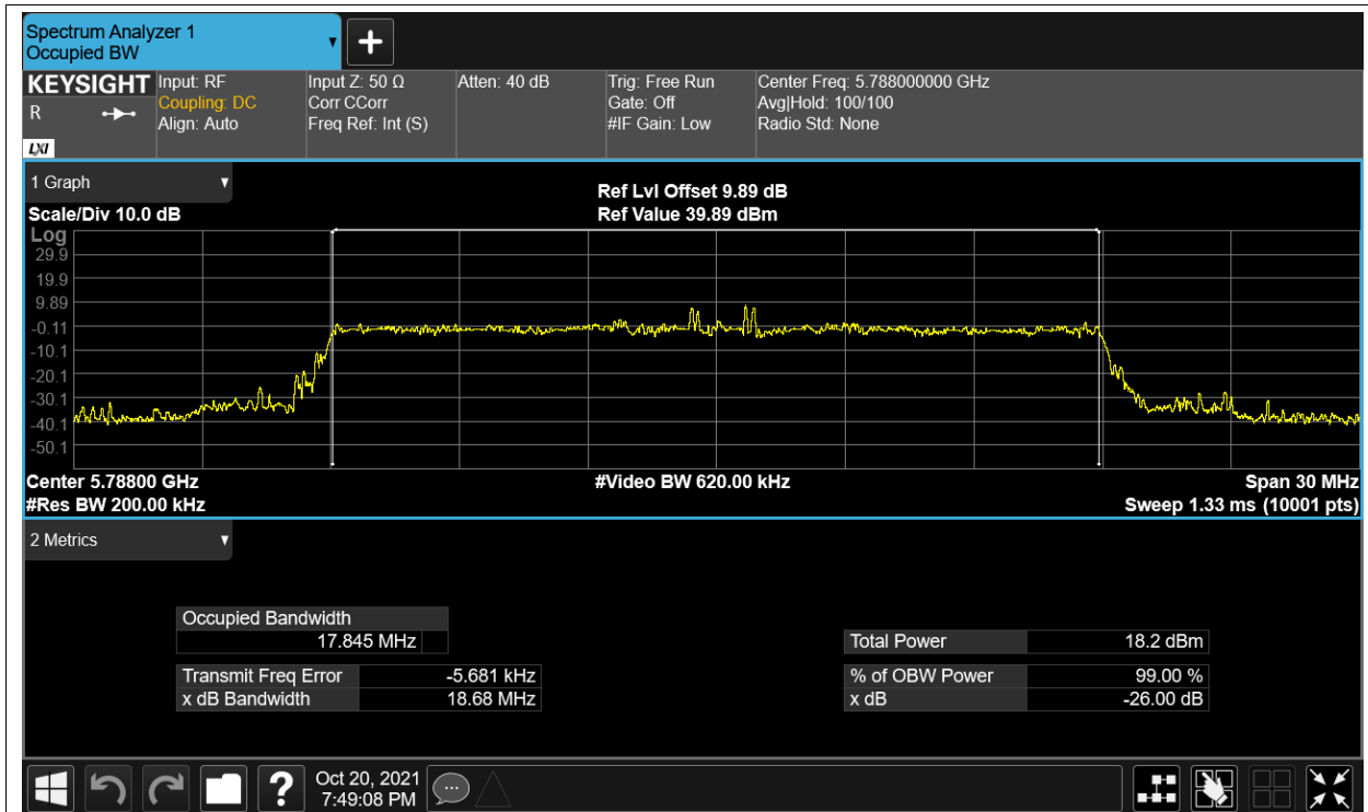
OBW HVHT 5.8G-20M-16QAM 5788MHz Ant2
