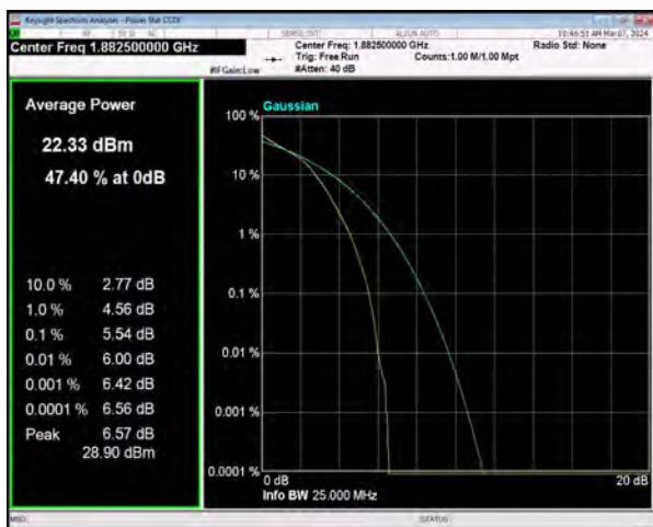
n25 SCS=15kHz DFT_16QAM BW=20MHz Channel=376500 RB=100@0
