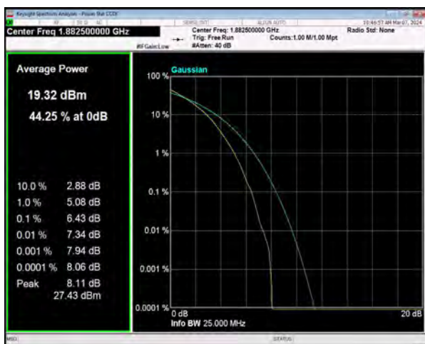
n25 SCS=15kHz DFT_256QAM BW=20MHz Channel=376500 RB=100@0
