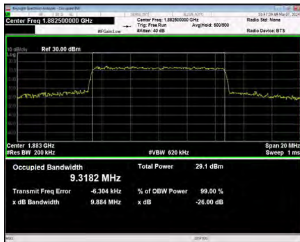
n25 SCS=15kHz CP_16QAM BW=10MHz Channel=376500 RB=52@0
