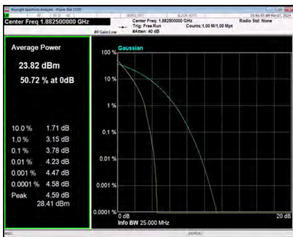
n25 SCS=15kHz DFT_BPSK BW=20MHz Channel=376500 RB=100@0
