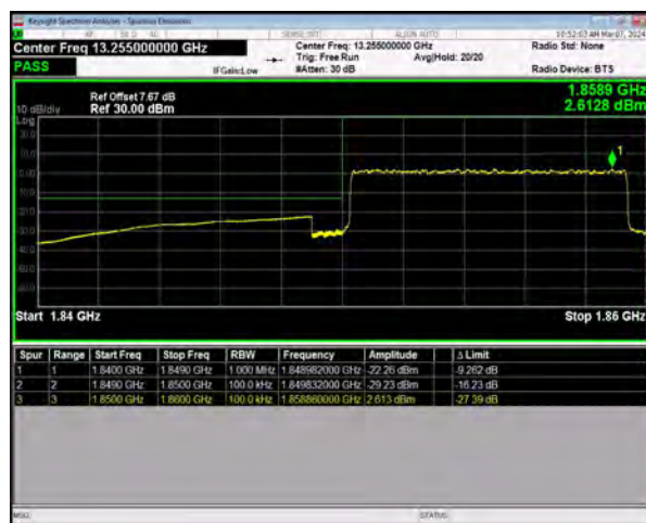
n25 SCS=15kHz DFT_QPSK BW=10MHz LowChannel=371000 RB=50@0
