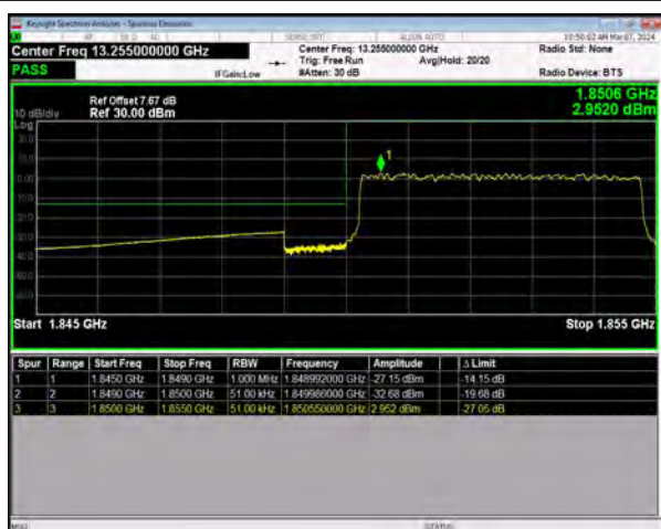
n25 SCS=15kHz CP_QPSK BW=5MHz LowChannel=370500 RB=25@0
