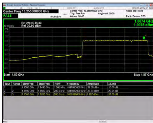
n25 SCS=15kHz DFT_BPSK BW=20MHz LowChannel=372000 RB=100@0
