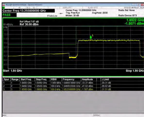
n25 SCS=15kHz DFT_256QAM BW=10MHz
