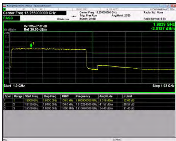
n25 SCS=15kHz DFT_256QAM BW=15MHz
