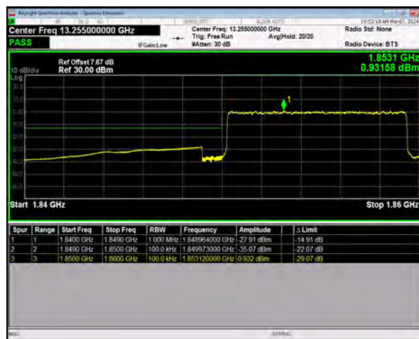
n25 SCS=15kHz DFT_16QAM BW=10MHz LowChannel=371000 RB=50@0
