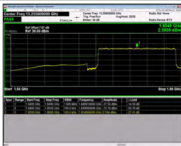
n25 SCS=15kHz DFT_BPSK BW=10MHz LowChannel=371000 RB=50@0
