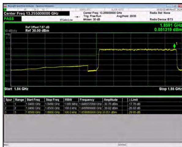
n25 SCS=15kHz DFT_64QAM BW=10MHz LowChannel=371000 RB=50@0
