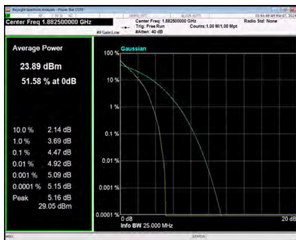
n25 SCS=15kHz DFT_QPSK BW=20MHz Channel=376500 RB=100@0
