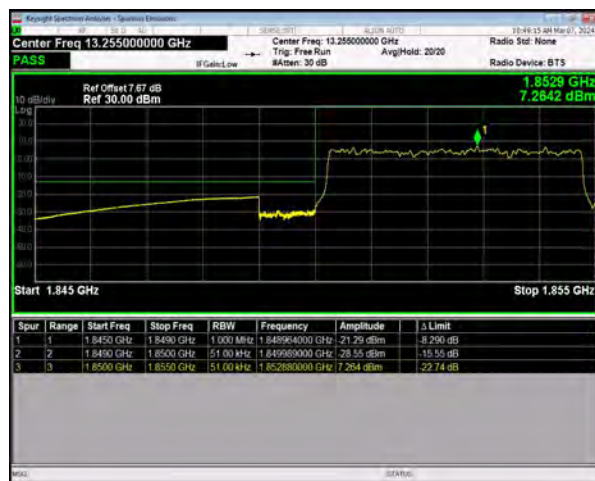
n25 SCS=15kHz DFT_QPSK BW=5MHz LowChannel=370500 RB=25@0
