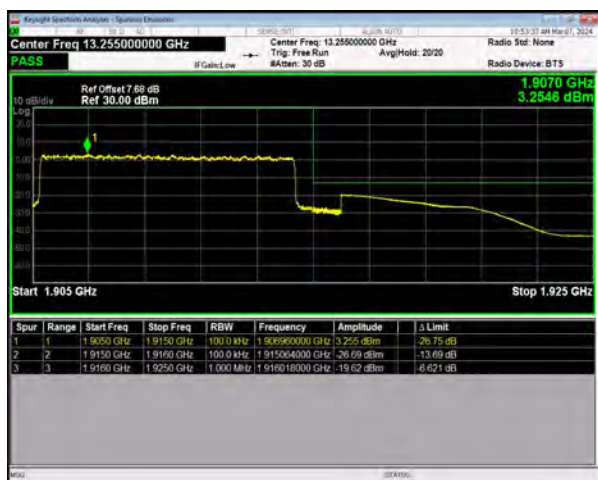
n25 SCS=15kHz DFT_QPSK BW=10MHz HighChannel=382000 RB=50@0
