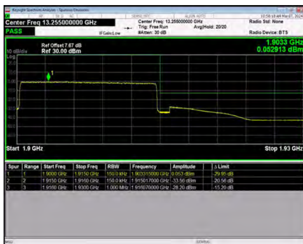
n25 SCS=15kHz CP_QPSK BW=15MHz HighChannel=381500
