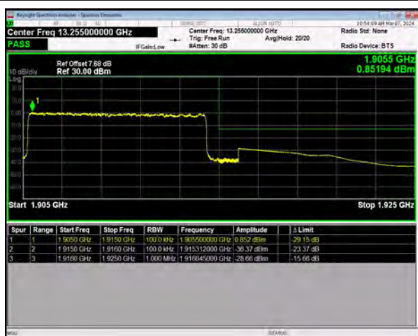
n25 SCS=15kHz DFT_64QAM BW=10MHz HighChannel=382000 RB=50@0
