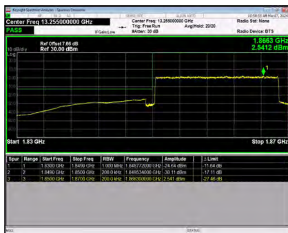
n25 SCS=15kHz DFT_QPSK BW=20MHz LowChannel=372000 RB=100@0
