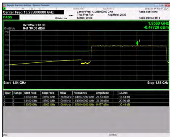
n25 SCS=15kHz CP_QPSK BW=10MHz LowChannel=371000
