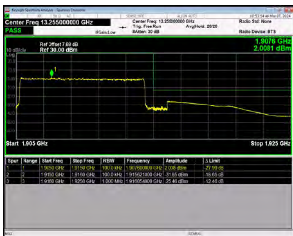
n25 SCS=15kHz DFT_16QAM BW=10MHz HighChannel=382000 RB=50@0
