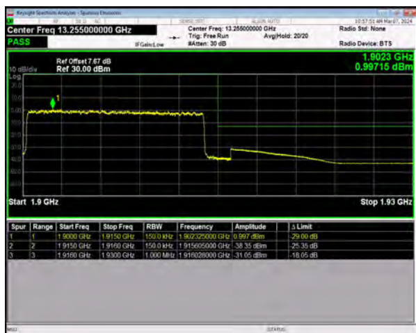
n25 SCS=15kHz DFT_64QAM BW=15MHz
