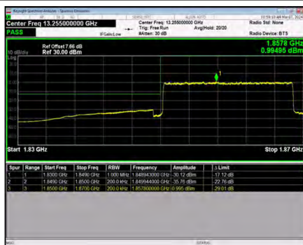
n25 SCS=15kHz DFT_16QAM BW=20MHz LowChannel=372000 RB=100@0
