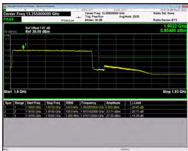
n25 SCS=15kHz DFT_16QAM BW=15MHz
