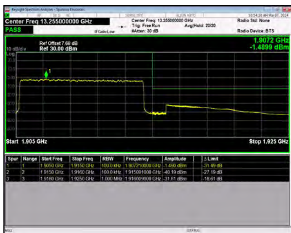
n25 SCS=15kHz DFT_256QAM BW=10MHz HighChannel=382000 RB=50@0
