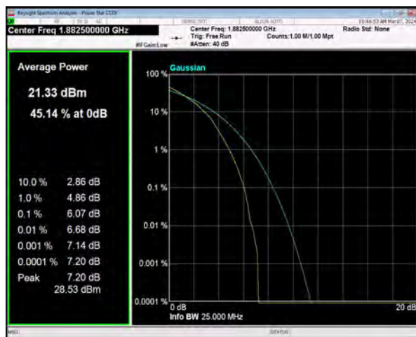
n25 SCS=15kHz DFT_64QAM BW=20MHz Channel=376500 RB=100@0
