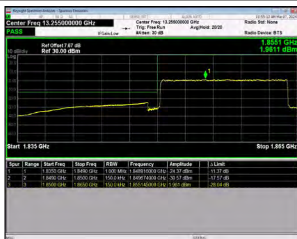
n25 SCS=15kHz DFT_QPSK BW=15MHz LowChannel=371500 RB=75@0
