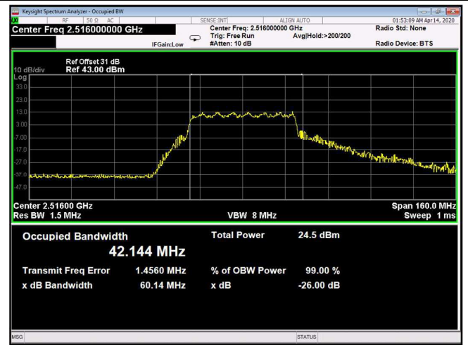
Figure 330: 16QAM 40MHz B.W.; 2516.0MHz, 15kHz Output
