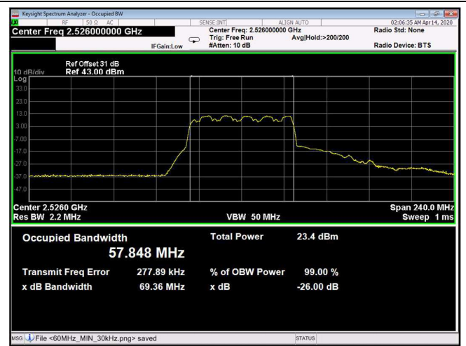
Figure 340: 16QAM 60MHz B.W.; 2526.0MHz, 60kHz Output
