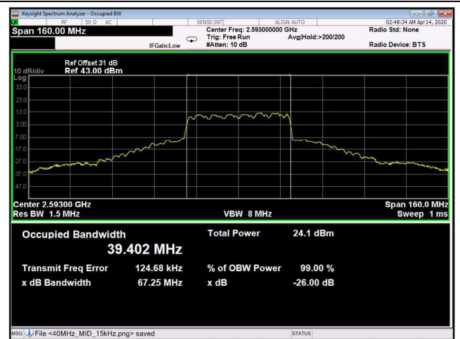
Figure 334: 16QAM 40MHz B.W.; 2593.0MHz, 30kHz Output
