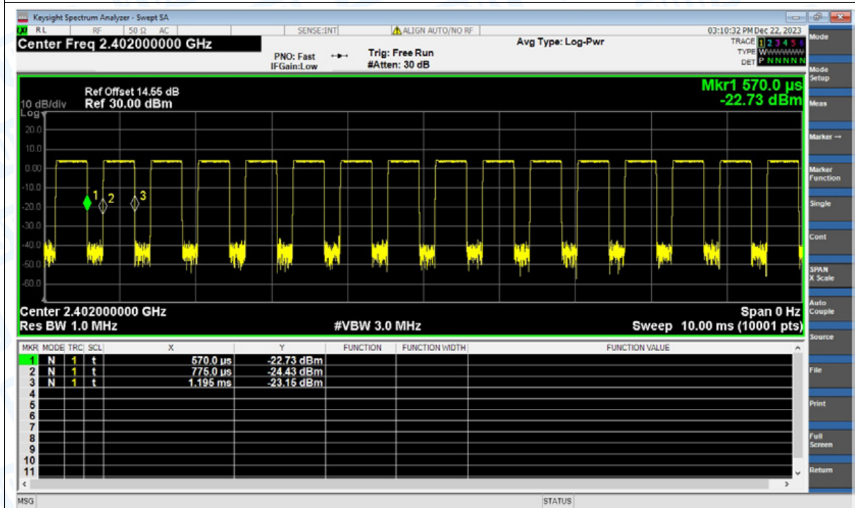
Duty Cycle NVNT BLE 1Mbps 2440MHz Ant1
