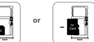
• on il pad rivolto a faccia in su, inserisci il carrello sim nel pad seguendo la direzione della freccia.
