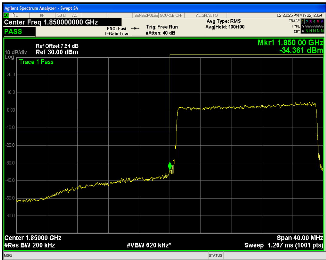
Band2 QPSK BW=20MHz Channel=19100 RB Size=100 Position=#0
