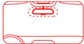
Nota: Asegúrese de pegar la pegatina electrostática en una parte plana y lisa del parabrisas, presiónela firmemente y evite pegarla en el borde de la película del parabrisas para evitar que se caiga.
