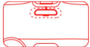
メモ:静電防止ラベルはフロントガラスの平らな部分に貼り付け、強く押して、フロントガラスフィルムの端に貼り付けないようにして、落下しないようにしてください。
