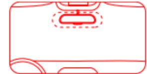
提示: 確保將靜電標籤粘貼在擋風玻璃的平坦部分之上, 用力按壓, 並避免將其粘貼在擋風玻璃薄膜的邊緣, 以防掉其掉落。
