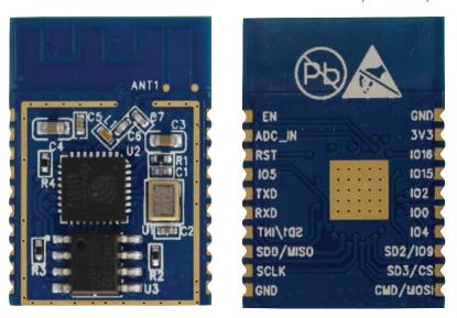
Figure 1-1. ESP-WROOM-S2 Module
